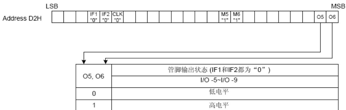
输出寄存器.....输入寄存器 (D2H) 的位M5~M6可以作为输出寄存器 (D3H) 的串行输出数据M5~M6
